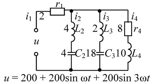
Рис. 24. Схема электрической цепи несинусоидального периодического напряжения
