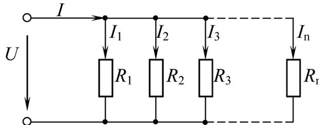
Рис. 10. Параллельное соединение элементов электрической цепи
