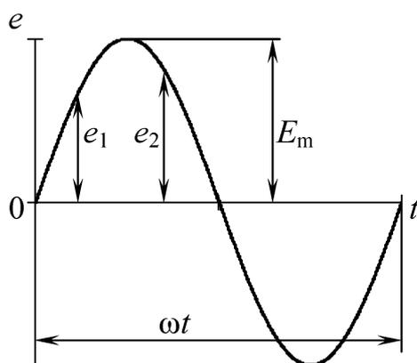
Рис. 14. Графическое изображение синусоидальной ЭДС
