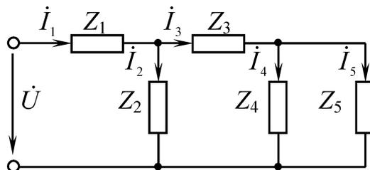
Рис. 19. Расчётная схема электрической цепи
