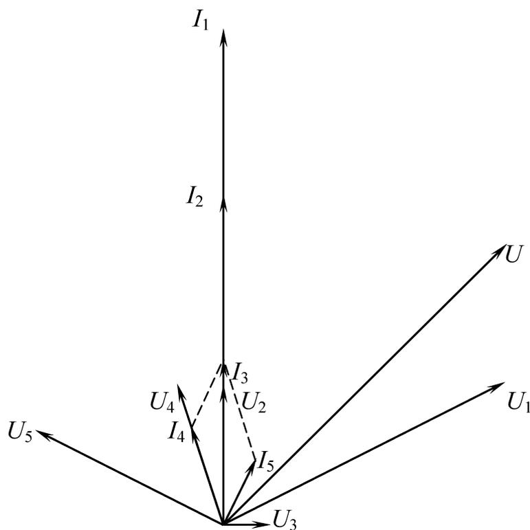
Рис. 22. Векторная диаграмма токов и напряжений
