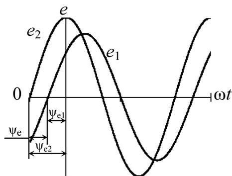
Рис. 17. Синусоидальные ЭДС при  $\psi_{e2} > \psi_{e1}$
