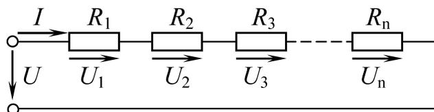
Рис. 9. Последовательное соединение элементов электрической цепи
