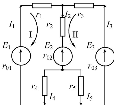
Рис.12. Схема цепи постоянного тока
