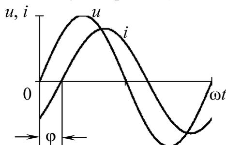
Рис. 18. Синусоидальные напряжения и ток при  $\varphi > 0$
