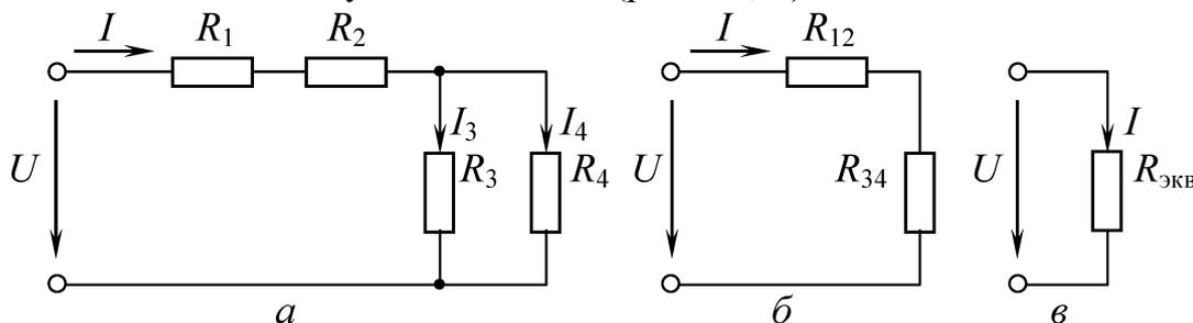
Рис. 11. Смешанное соединение элементов электрической цепи
