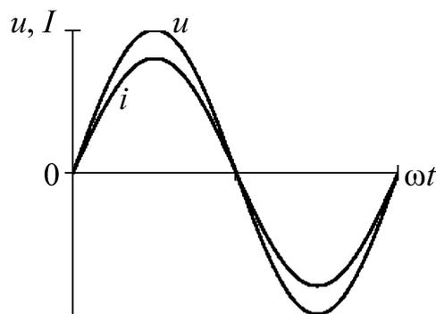
Рис. 15. Синусоидальные напряжения и ток при  $\psi_u = \psi_i = 0$
