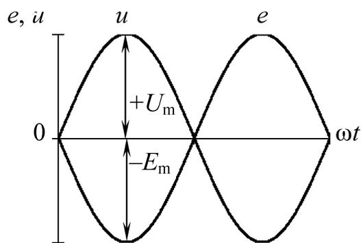
Рис. 16. Синусоидальные напряжения и ЭДС при  $\psi_u = 0$  и  $\psi_e = \pi$
