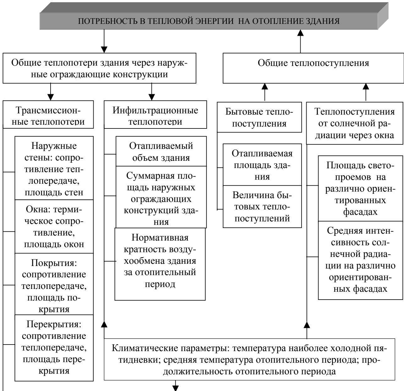
Рис. 23. Тепловой баланс здания
