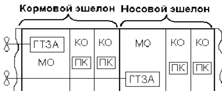
Рис. 5. Эшелонное размещение машинно-котельных групп
