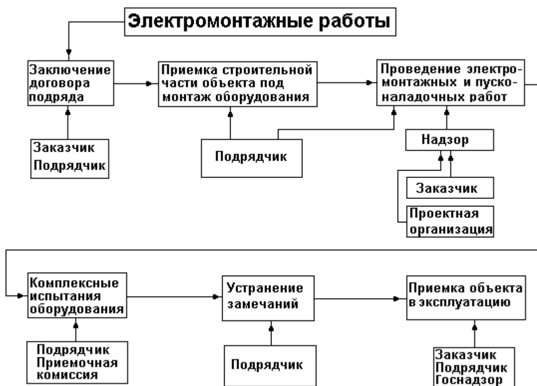
Рис. 1.1. Основные этапы проведения электромонтажных работ
