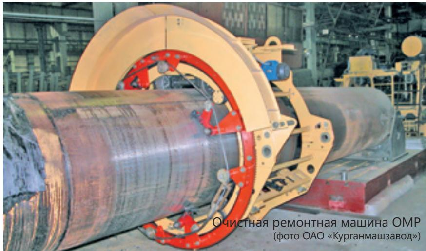
Очистная ремонтная машина ОМР
