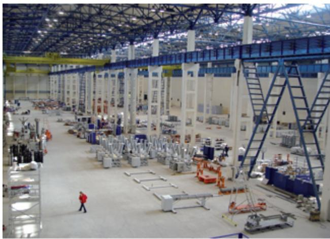
**Цех по производству ВВА. В цехе реализован принцип гибкой мобильной технологии, позволяющий быстро расширять и перемещать участки сборки разных изделий согласно производственной необходимости**
