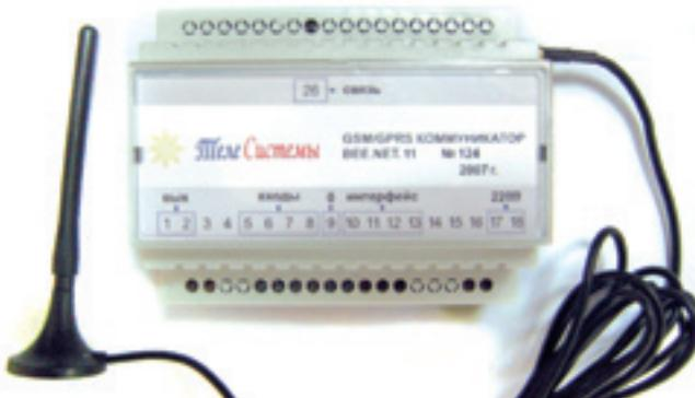
Второй способ – счетчик электрической энергии устанавливается внутри частного владения или на опоре линии электропередачи 0,4 кВ. Рядом со счетчиком устанавливается PLC модем, работающий по сети 0,4 кВ, обладающий возможностью ретрансляции данных. Далее, сеть PLC модемов подключается к GPRS коммуникатору и опрос счетчиков производится через Интернет.
