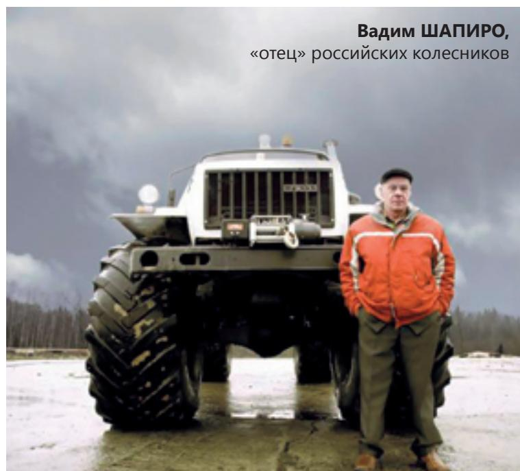
Однако изумительное сцепление с грунтом может сыграть злую шутку с владельцем вездехода. На твердом грунте пневматики создают защемленную конструкцию – их невозможно загнать в пробуксовку (не хватает мощности обычного мотора) и при максимальных оборотах двигателя на пониженной первой передаче легко порвать трансмиссию».
