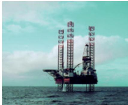
ЛСП-2 изготовлена на заводе по производству строительных металлоконструкций ООО «ЛУКОЙЛ-Калининградморнефть» и в виде отдельных монтажных модулей и блоков доставлена на речных баржах в Астрахань для дооборудования и укрупненной сборки на площадке Астраханского Судостроительного Производственного Объединения.
