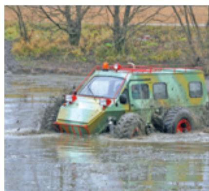
«Объединением проектировщиков предприятий» по заказу ОАО «Авторос», - прим. ред.] И в первый же день у него срезало редуктор. Ущербность этой схемы поняли в «Арктиктрансе», поэтому их «Лопасня» не имеет блокировок вообще. Но так как используются колеса 1200 мм и более, а передние редукторы и приводы взяты
