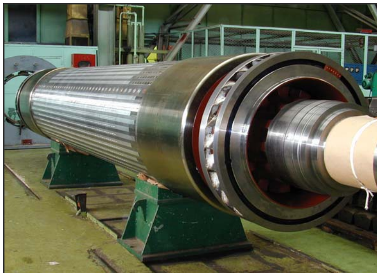
Рис.4. Ротор турбогенератора с воздушным охлаждением
